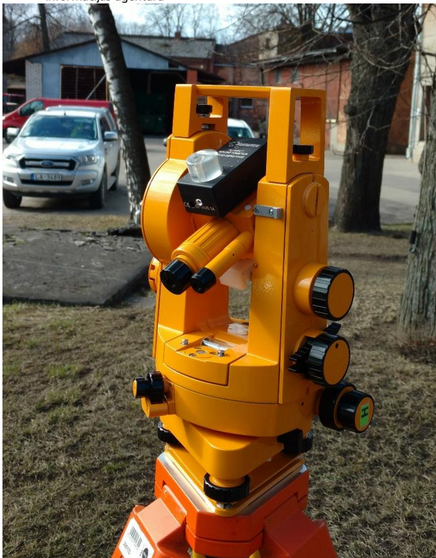
Magnetometers Araconsys-fluxset H100 un teodolīts Theo 010B
