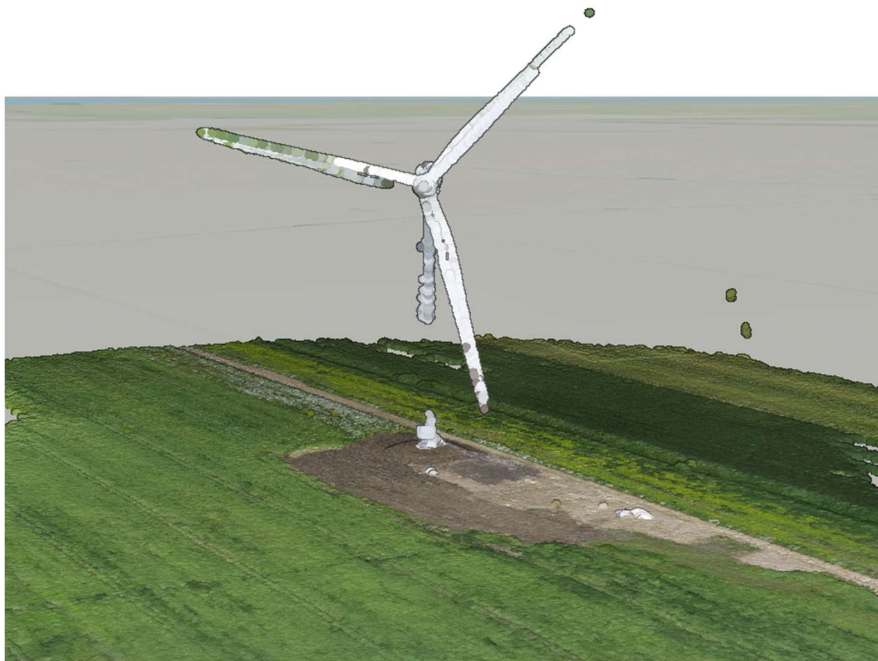
Vēja ģenerators – punktu mākonis
